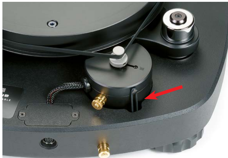
Der flexibel montierte Motor wird vom Riemen beim Start zum Teller gezogen. Ein Gummiring (Pfeil) gleicht dieses Zugmoment aus.
